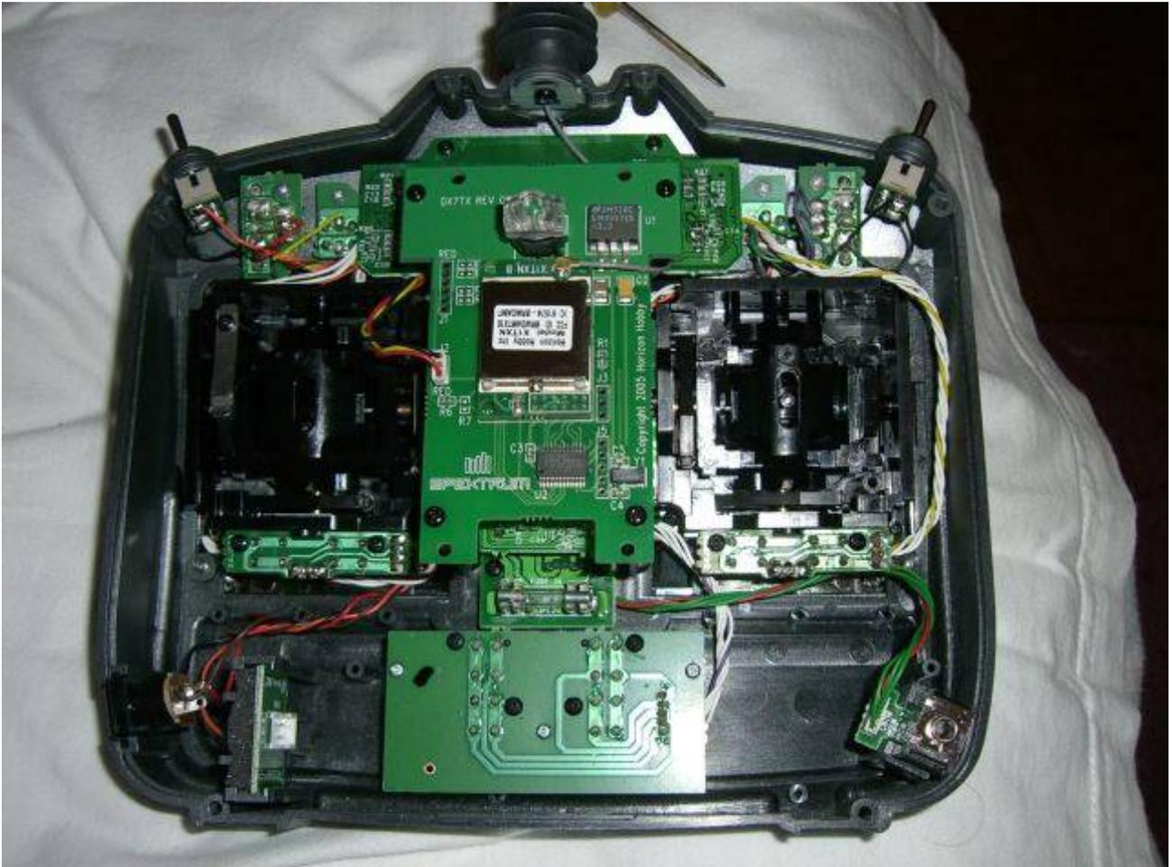
Man erkennt oben das Funkmodul - dieses ist vollständig von der eigentlichen Anlage getrennt und wird von vier Plastikabstandshaltern getragen. Alle Verbindungen bis auf die HF-Antennenklemme an dem Funkmodul sind gelötet.
